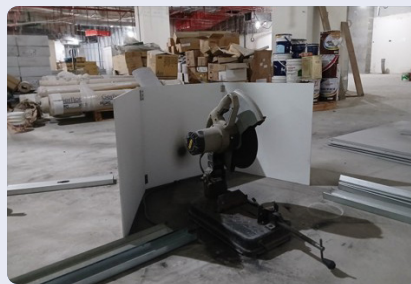
以集星罩防止研磨造成火星噴濺
