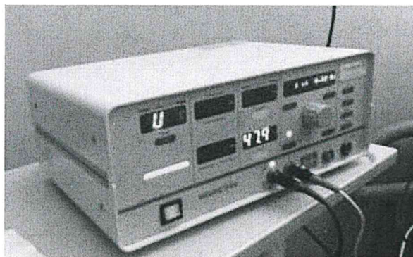
Fig 11. IONMED NEURO N50 的電燒機
