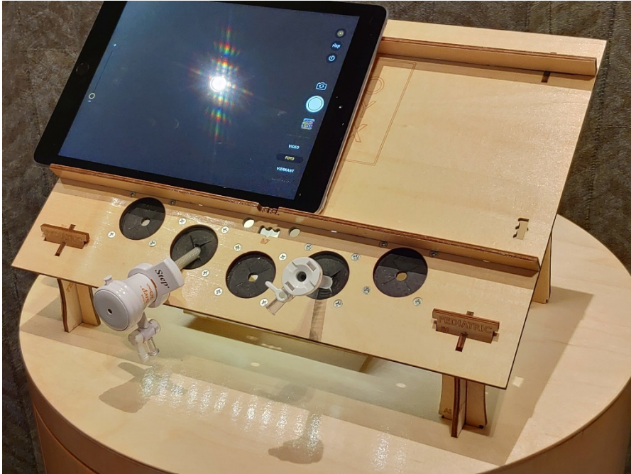
荷蘭 Nijmegen 小兒外科醫師研發的小兒外科內視鏡練習器，採木板雷射切割組合而成，目前已商品化
