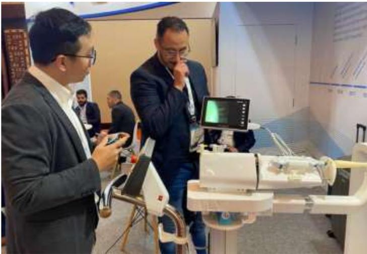
圖七、PS5 搖桿搭配操控軟式輸尿管鏡之機器手臂
