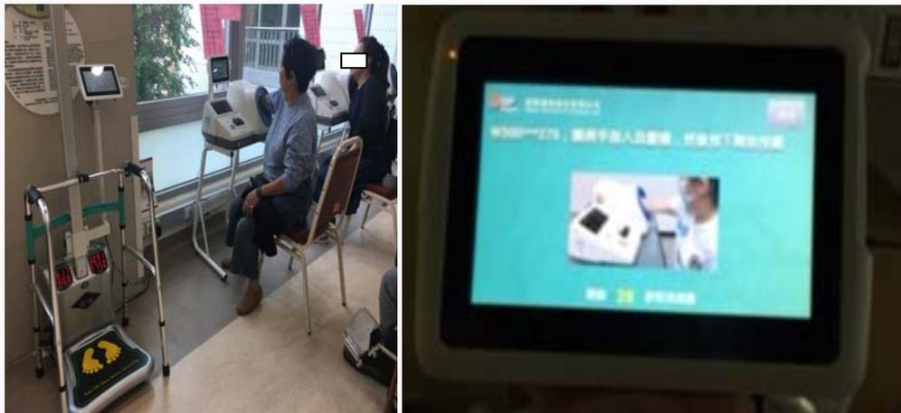
圖二 自動生理監測上傳機器具有中英文語音操作、及文字操作說明
