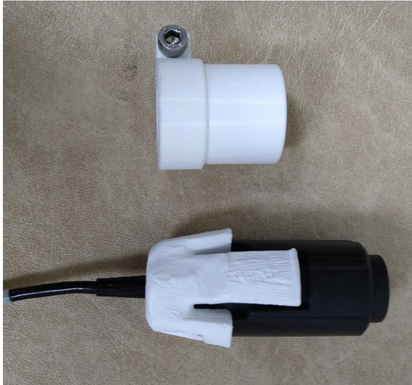
圖 1: 白色部分為 3D 列印護套。上方為新式環狀護套、下方為電腦斷層掃描仿製護套。
