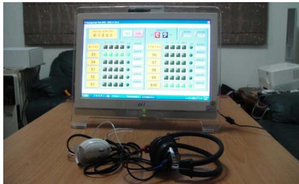
圖 3：聽力量值觸控式聽力檢測儀器
