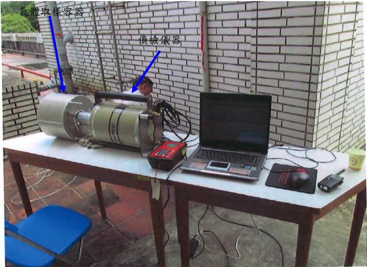
圖 13 放射性廢氣排放處理過濾系統及現場檢測作業
